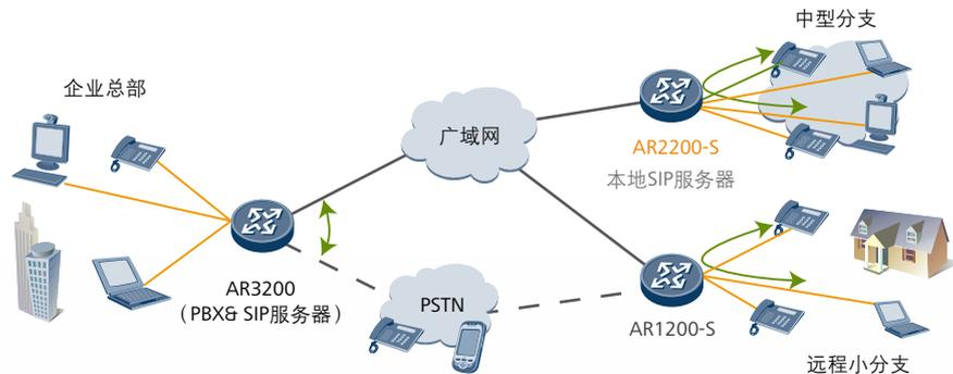
AR系列企业路由器内置PBX，提供企业总机、IVR语言导航、话单查询等语音通信业务，有效提升企业形象，提高企业内外的沟通效率。AR2200-S部署在企业分支，支持智能路由拨号功能，可以根据目的号码段智能选择出口链路，节省企业分支话费开支。
