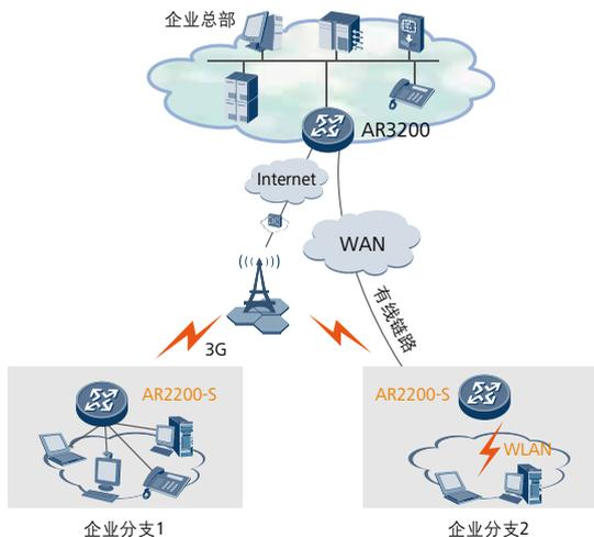
AR2200-S系列企业路由器集成了3G和LTE等无线接入功能，支持CDMA2000 EV-DO、WCDMA的3G标准，满足企业分支机构之间以及与总部间的无线互联需求。采用3G USB数据卡接入方式，客户在AR上部署3G业务时，不占用设备的业务槽位，最大程度保护客户的投资。同时，3G数据链路可以作为有线链路的备份链路，对AR上行的xDSL、FE/GE、ISDN、CPOS等链路提供链路保护，有效提高网络的稳定性，降低网络建设成本。NQA技术还可以实时监控3G链路质量，有效保证用户的SLA。
