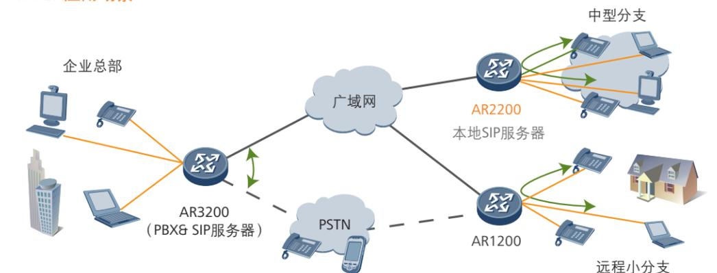
AR系列企业路由器内置PBX，提供企业总机、IVR语言导航、话单查询等语音通信业务，有效提升企业形象，提高企业内外的沟通效率。AR2200部署在企业分支，支持智能路由拨号功能，可以根据目的号码段智能选择出口链路，节省企业分支话费开支。
