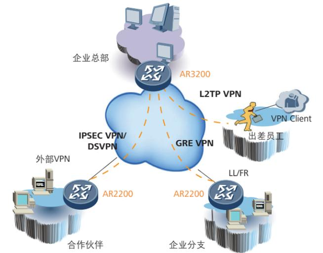
AR2200系列企业路由器提供支持国密算法的接口卡，插卡灵活，满足用户对业务安全性的扩展需求。通过硬件完成数据的加密和解密，极大提高了数据的加密和解密性能，为客户提供端到端的安全保障。
