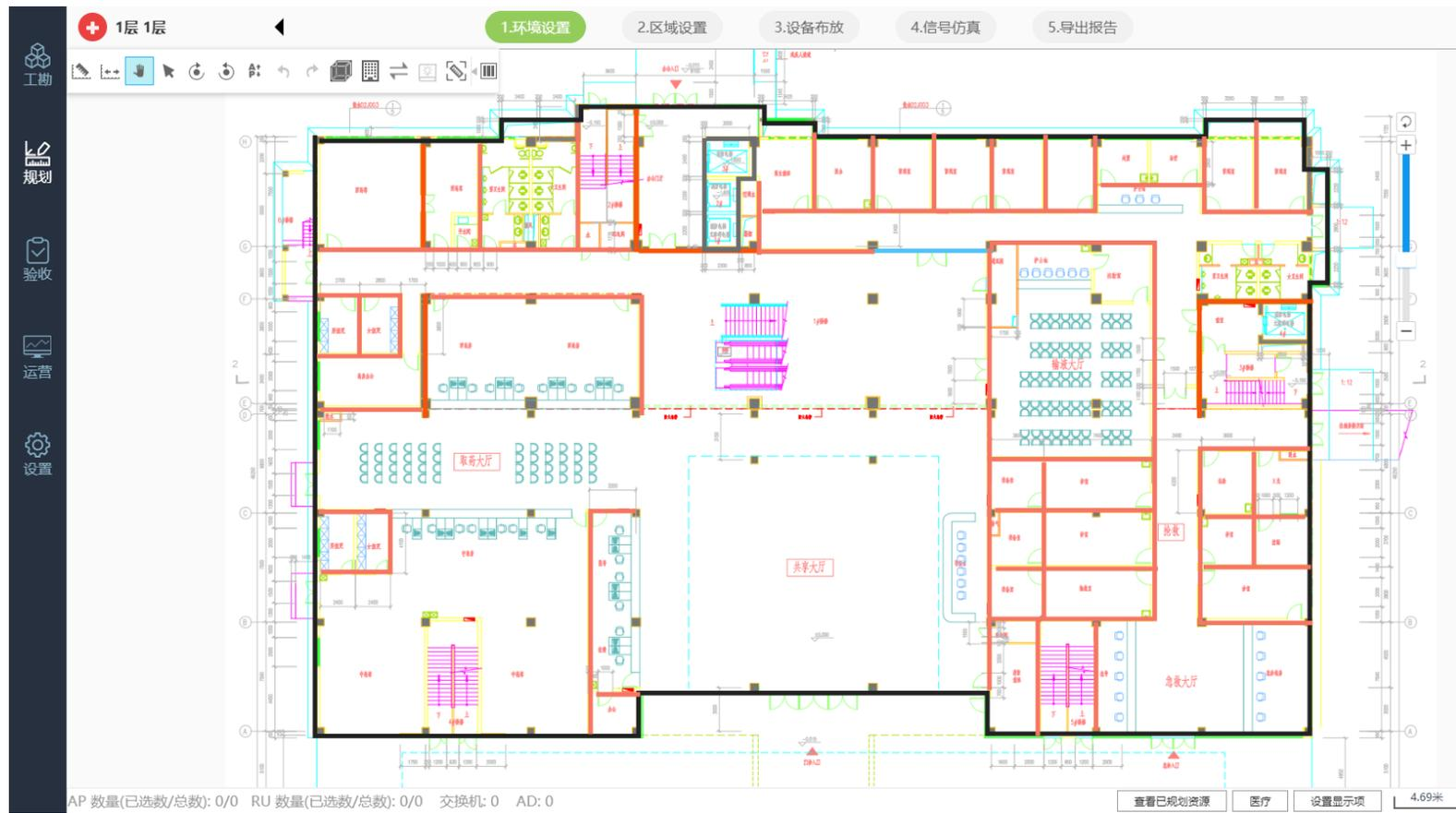
在工具（地址：<https://serviceturbo-cloud.huawei.com>）中新建项目，导入图纸并设置好比例尺之后，根据收集到的墙体类型画障碍物，工具中预置了多种常见墙体，上图深红色墙体为厚砖墙，浅红色是薄砖墙。
