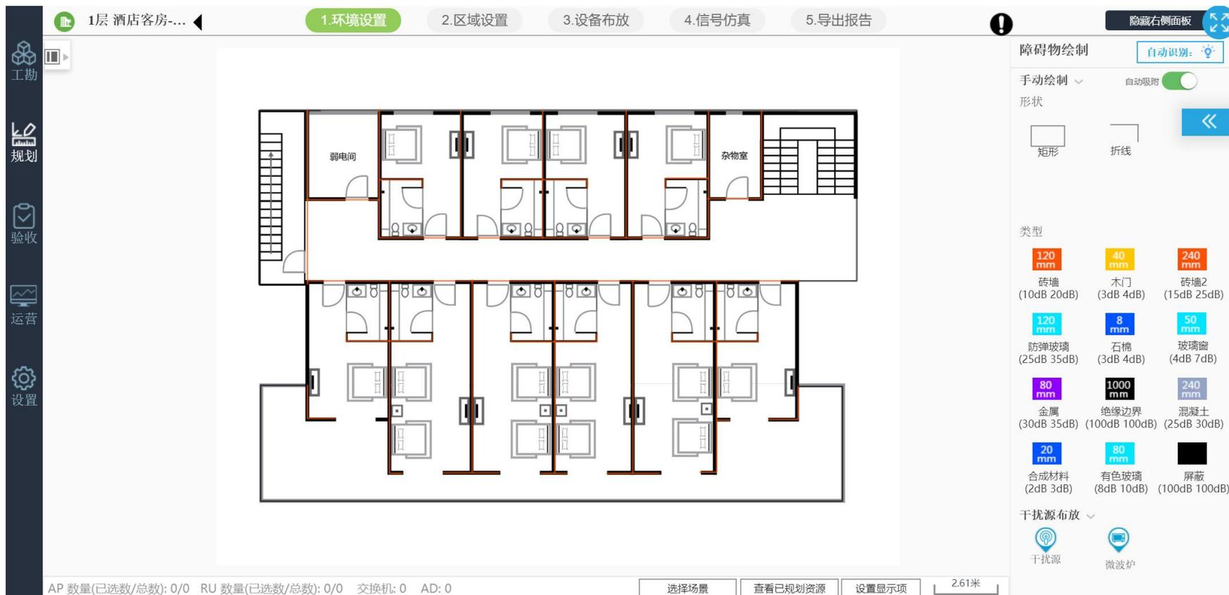
新建项目，导入图纸并设置好比例尺之后，根据收集到的墙体类型画障碍物，工具中预置了多种常见墙体，上图红色墙体为厚砖墙。
