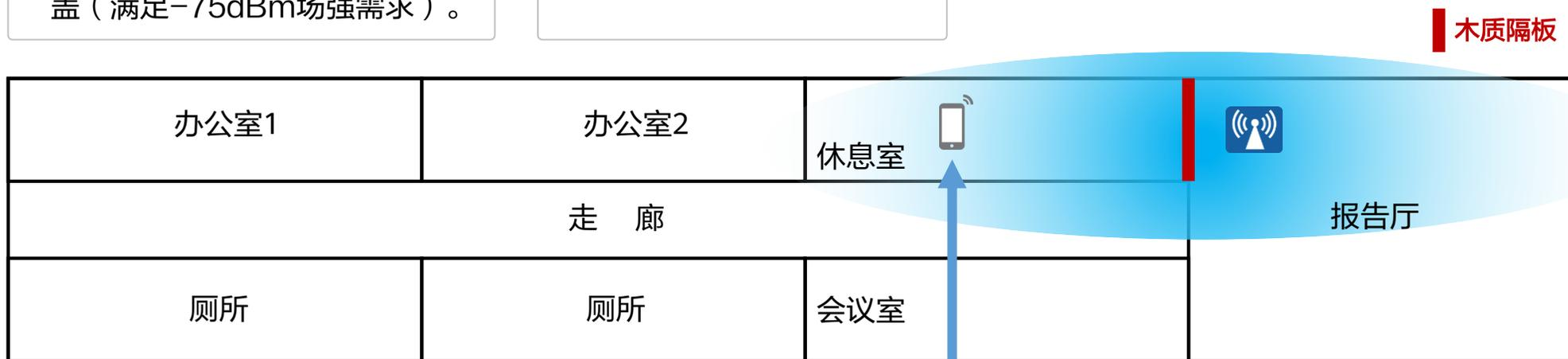
图示手机位置的信号场强=20（AP发射功率建议值）+3（天线增益值）-60（传输距离衰减值）-5（障碍物信号衰减）
