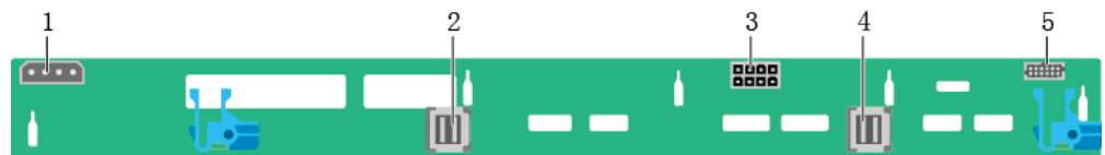
图5-42 8x2.5 英寸硬盘背板（8xSAS/SATA）（BOM：03024NKF、03029JRX）
