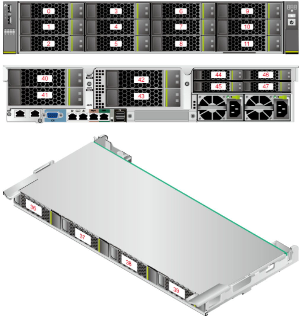
图5-30 硬盘编号（以 IO 模组 1 配置 2x3.5 英寸 SAS/SATA 硬盘为例）
