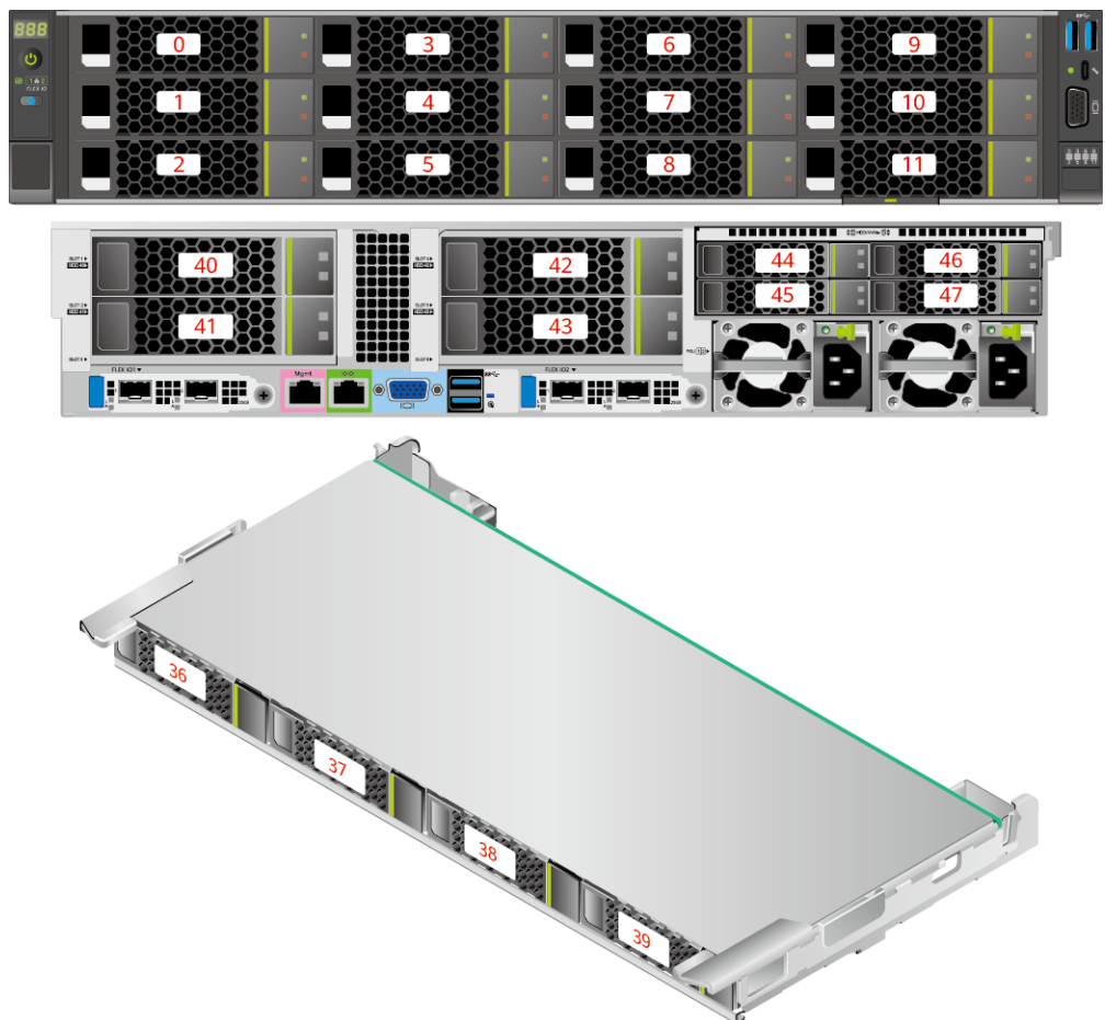
图5-44 硬盘编号（IO 模组 1 和 IO 模组 2 配置 3.5 英寸硬盘）
