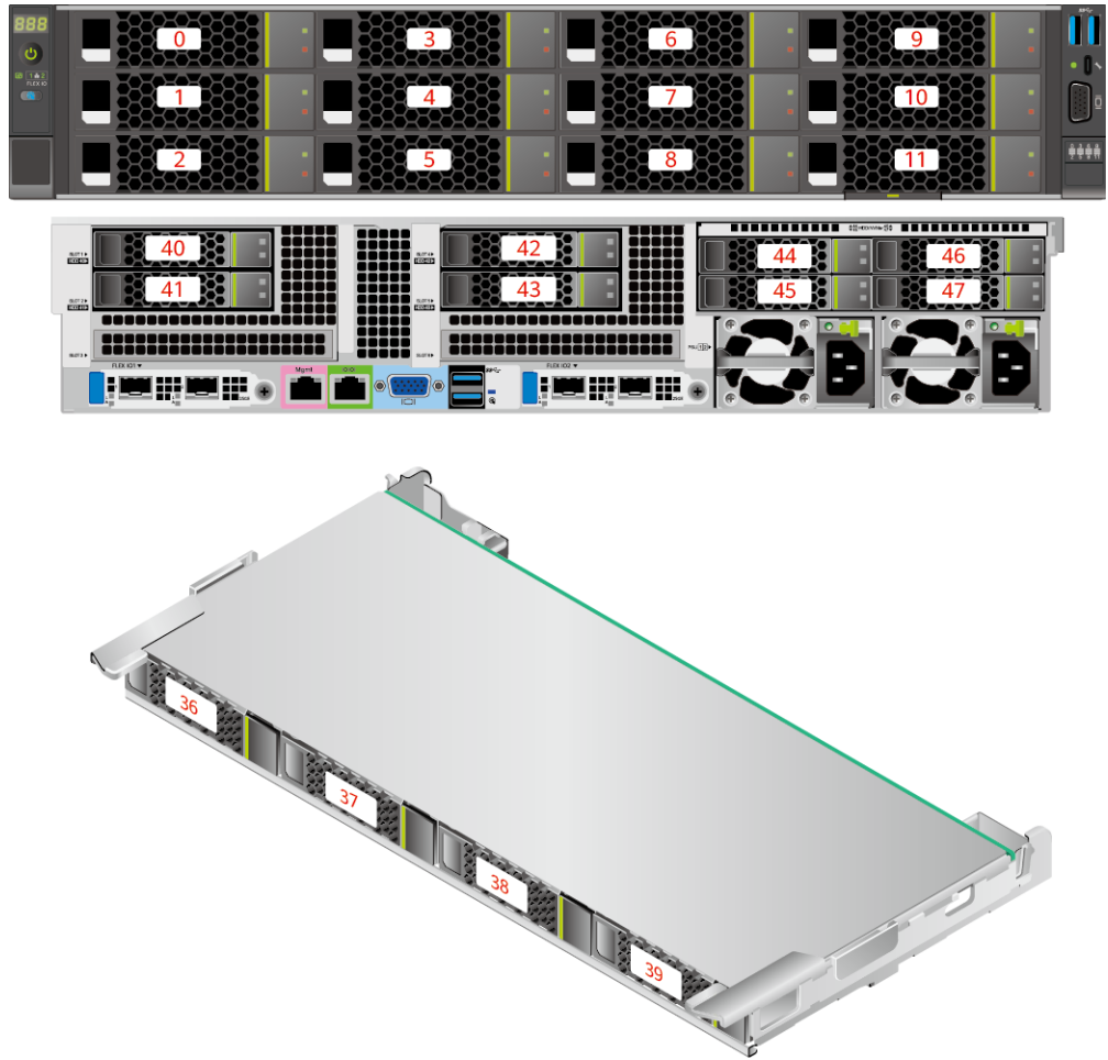
图5-45 硬盘编号（IO 模组 1 和 IO 模组 2 配置 2.5 英寸硬盘）
