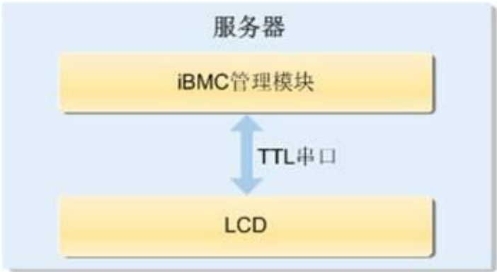
图5-28 LCD 子系统工作原理
