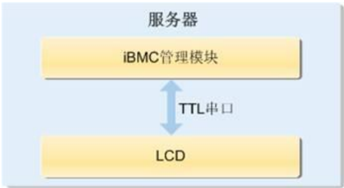
图5-35 LCD 子系统工作原理
